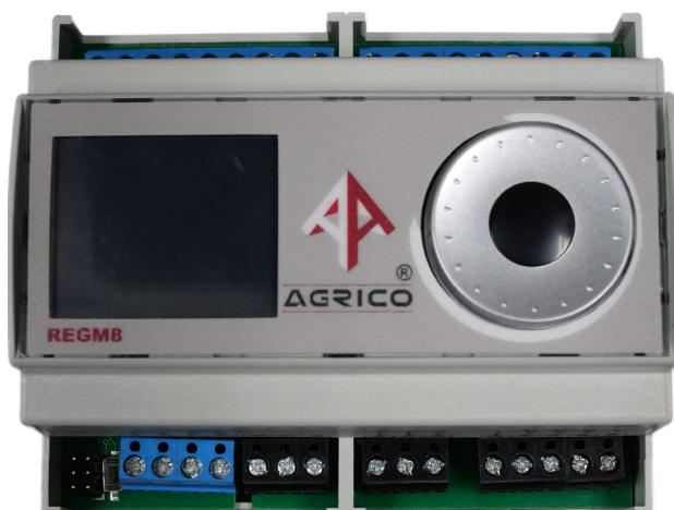
Řídící jednotka REGM8 je vybavena procesorem typu ARM, WiFi modulem, kterým se může připojit k síti. REGM8 umožnuje měřit interní i externí teplotu pomocí teplotních sond, interní vlhkost, koncentraci CO<sub>2</sub>, koncentraci NH<sub>3</sub> a pomocí tenzometrů nebo radarových snímačů hmotnost krmné směsi v silech.
